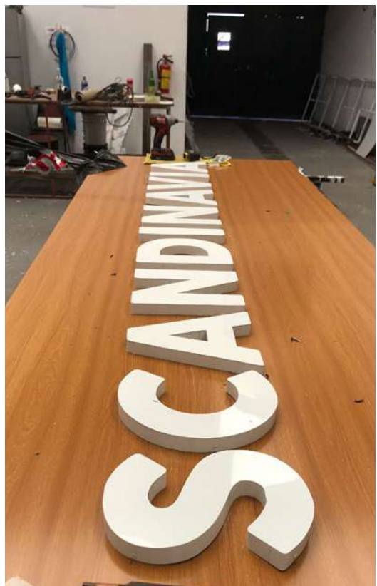
LETRAS EN ALUMINIO, PINTADO AL COLOR INSTITUCIONAL, SECADO AL HORNO PUEDEN SER CON LUZ O SIN LUZ
